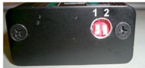
Abbildung 4 DIP-Schalter und Zündkurvenauswahl.
