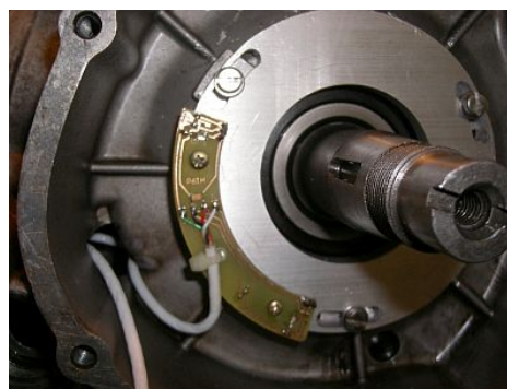
Montage des neuen Pickups.
