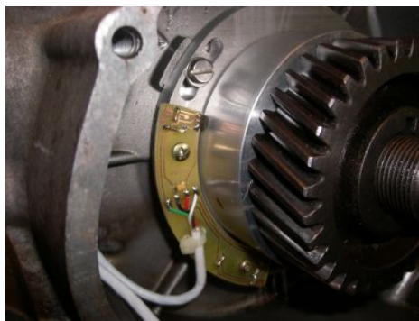
Befestigung des neuen Magnetringes am Primärzahnrad.
