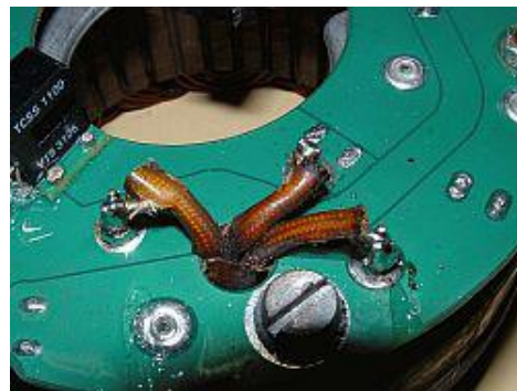
Abbildung 3 Anlöten der drei Statorphasen
