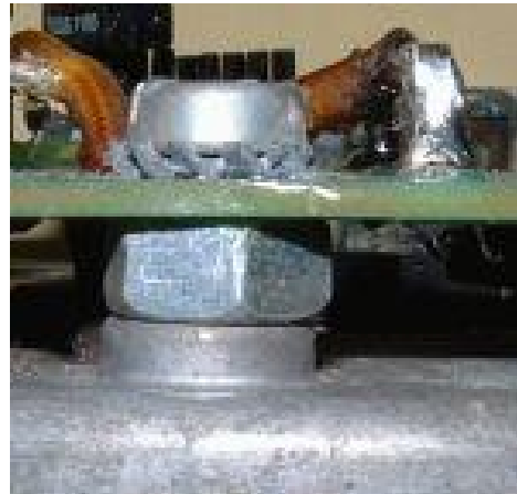
Abbildung 2 M6-Mutter als Distanzstück
